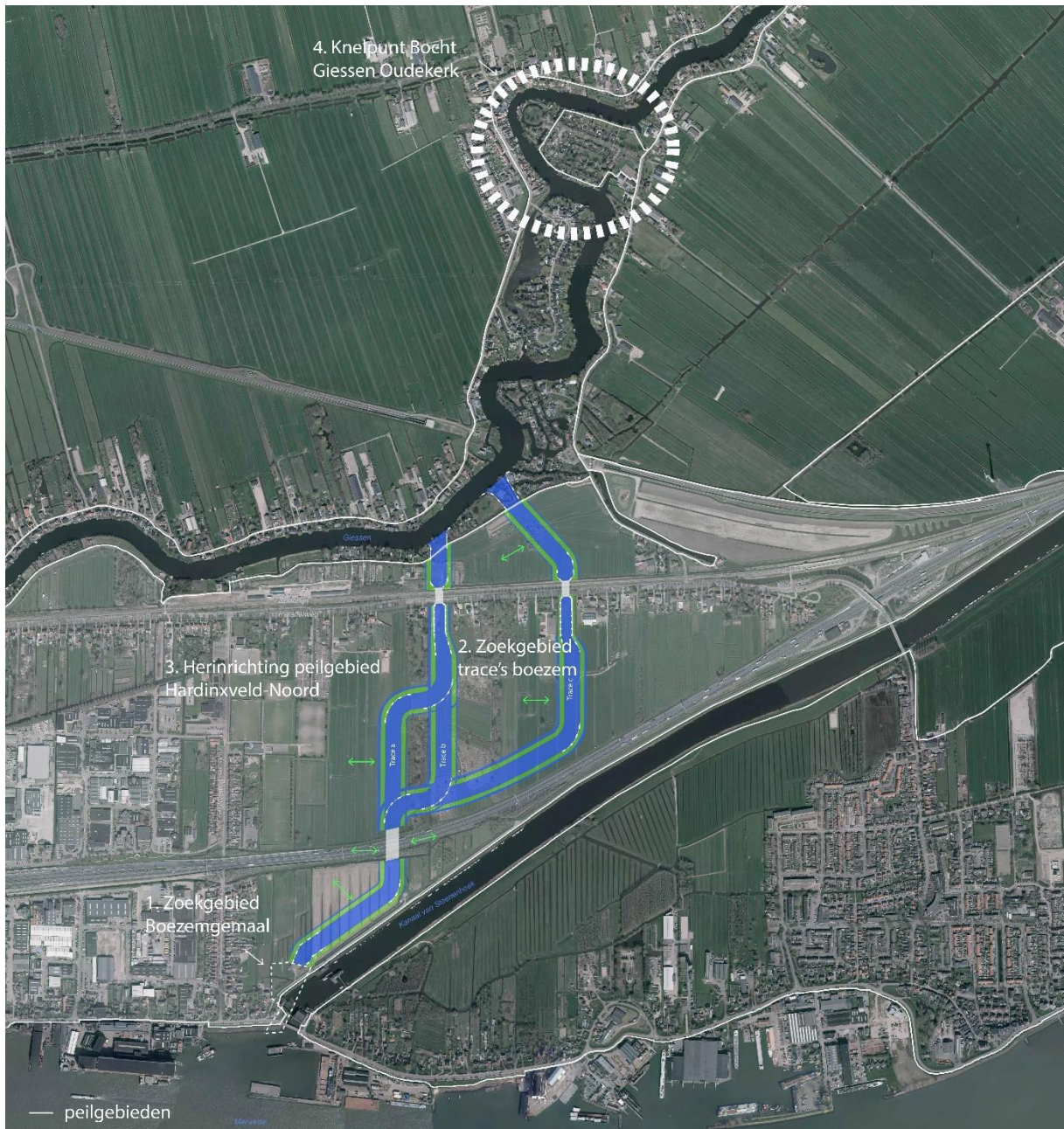
Figuur 2: Overzicht van de locatie voor (1) nieuwe boezemgemaal (2) boezemtracé Overwaard bij locatiekeuze Hardinxveld (3) herinrichten peilgebied polder HN en (4) oplossen knelpunt in de bocht Giessen-Oudekerk.
